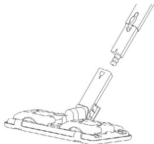
Enfoncez l'embouchure de la brosse spéciale sol dans l'extrémité du tube d'extension. Veillez à ce que l'embouchure émette un « clic » une fois en place lors de l'assemblage. La brosse spéciale sol est idéale pour nettoyer les murs lavables et les revêtements de sol. Elle peut être utilisée avec ou sans la serviette. Appuyez sur le côté intérieur du support, ouvrez les clips pour retenir la serviette.
