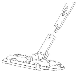
Bocal da escova para pavimentos na extremidade do tubo extensível. Assegurar que o bocal se fixa na respetiva posição da unidade. A escova para pavimentos é ideal para limpar paredes laváveis e revestimentos de chão. Pode ser utilizada com ou sem o toalhete. Fazer pressão no interior do suporte, abrir os cliques para segurar o toalhete.
