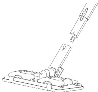
Fissare la spazzola lavapavimenti all'estremità del tubo di prolunga. Assicurarsi che la faccia click per una installazione sicura. La spazzola per pavimenti è ideale per la pulizia di superfici lavabili e per pavimenti rivestiti. Può essere usata con e senza asciugamano. Fare pressione sul lato interno del supporto, aprire i fermi per tenere l'asciugamano.
