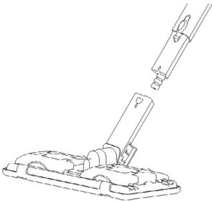
Boquilla del cepillo para el suelo al final del tubo de extensión. Asegúrese de que la boquilla haga clic en su lugar en el ensamblaje. El cepillo para el suelo es ideal para limpiar paredes lavables y revestimientos de suelos. Se puede usar con la toalla o sin ella. Presione el lado interior del soporte y abra los clips para sostener la toalla.
